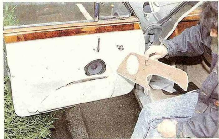
La portiera anteriore, di peso mastodontico, offre il supporto per il 13 cm, che è ottimamente celato da un pannellino, tenuto in mano dall'installatore e fissato alla portiera con automatici uso sartoria. Il gradino su cui poggia direttamente l'altoparlante è creato di sana pianta, non esisteva in origine, mentre il bracciolo è proprio inglese. Anche la funzionalità della tasca portaoggetti è stata mantenuta.
