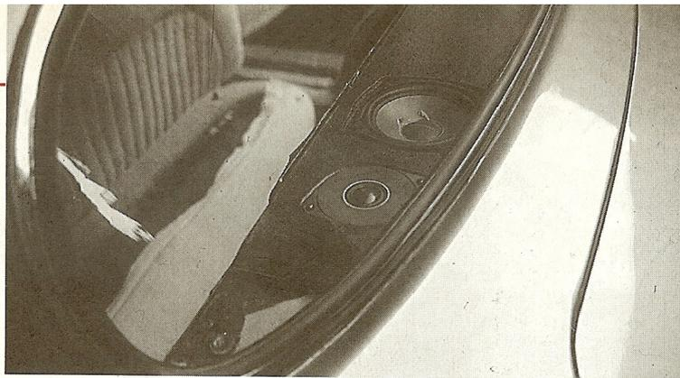
▲ *Non senza equilibrismi abbiamo ritratto il sistema chiuso posteriore con i due altoparlanti del System 10.*
